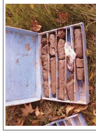
Foto 29: Sondaeig S-3 de 21.0-24.0 m.
