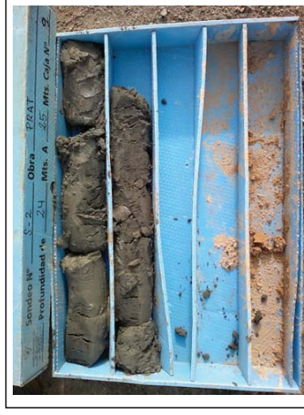
Foto 19: Sondaeig S-2 de 24.0-25.0 m.
