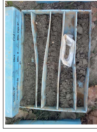
Foto 23: Sondaeig S-3 de 3.0-6.0 m.
