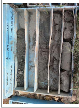
Foto 25: Sondaeig S-3 de 9.0-12.0 m.
