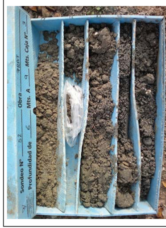
Foto 13: Sondaeig S-2 de 6.0-9.0 m.
