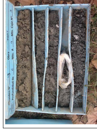
Foto 24: Sondaeig S-3 de 6.0-9.0 m.
