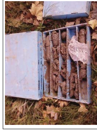
Foto 28: Sondaeig S-3 de 18.0-21.0 m.
